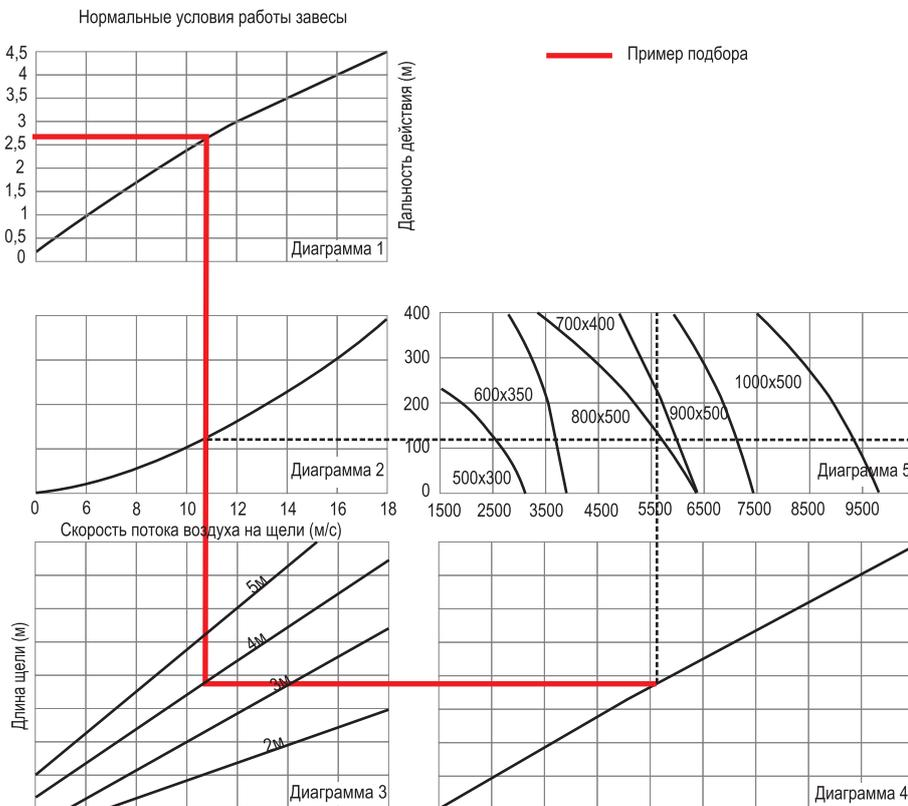
Результатом подбора воздушных завес является определение типоразмера завесы, необходимого для конкретных условий работы и конкретных проемов.
